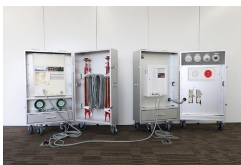
非常時放送機器および自動火災報知機
